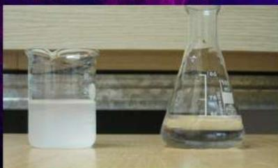
**Mescolando due** soluzioni incolori, si osserva inizialmente l'assenza di reazione visibile. Dopo un po', il liquido assume improvvisamente una tinta bluastro, caratterizzando la reazione di Landolt, una reazione oscillante scoperta nel 1886.
